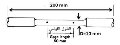
شكل (3). يوضح عينة قياسية لاختبار الشد
