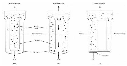
شكل 1 المفاعل الأنبوبي الهوائي: (a) الهواء يوجد في الأنبوب الداخلي. (b) الهواء يوجد في الأنبوب الخارجي. (c) مفاعل ذو الأنبوب الخارجي.
