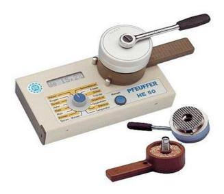
الشكل رقم . 2 . جهاز PfeufferGmbh HE 50 EC لقياس نسبة رطوبة الحبوب.
